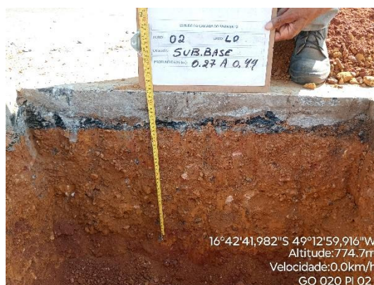
Figura 4 - Identificação das camadas e medição das espessuras.
