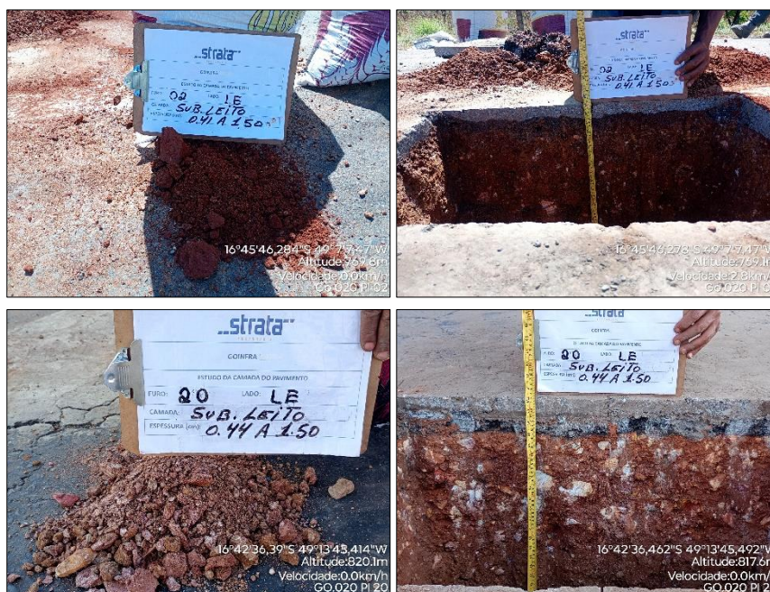
Figura 14 - Registro fotográfico do solo de fundação (solo argiloso e silte).
