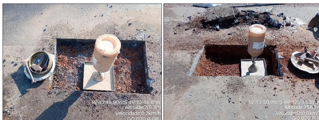
Figura 15 - Ensaio de Densidade In Situ.
