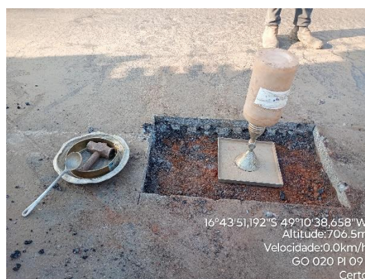
Figura 5 - Execução do ensaio de umidade e densidade in situ.
